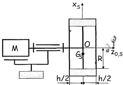
La roue est entraînée par un moteur  $M$  qui délivre un torseur couple  $C_m \bar{z}_0$
